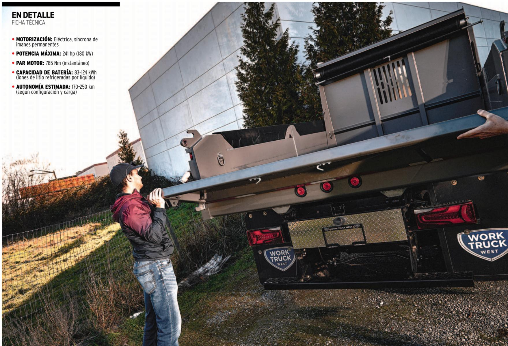
asistida eléctrica permiten maniobrar fácilmente en calles estrechas, estacionamientos o muelles de carga. La suspensión delantera independiente y los amortiguadores traseros neumáticos ofrecen una conducción estable y confortable, incluso con carga máxima.
