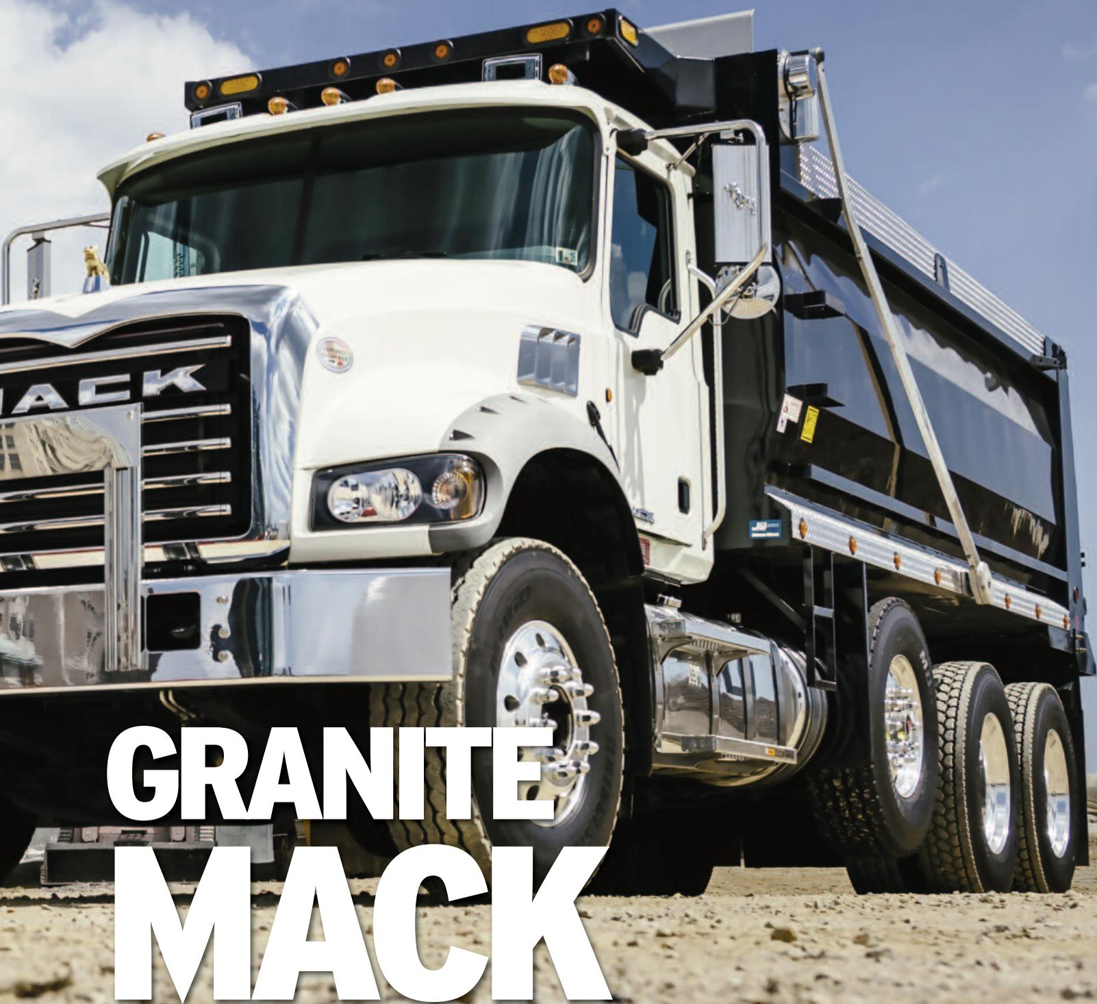
para soportar las condiciones más exigentes y, a pesar de su sólida naturaleza, fue construido utilizando materiales ligeros. Lleva una suspensión neumática montada diseñada para proveer mayor amortiguación, estabilidad y reducir la vibración; aún así, la verdad es que no le vendría mal un poco más de soporte, pues las irregularida-
