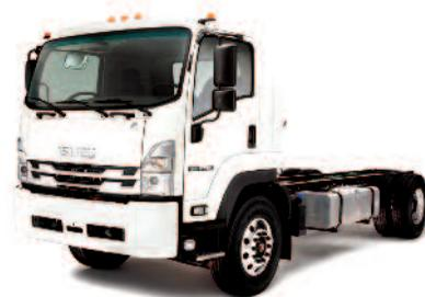
visibilidad y comodidad. Los conductores apreciarán el paso de rueda interior de 50 grados que le da al Isuzu F-Series diámetros de giro entre 43.7 pies (152 "WB) y 65 pies (248 "WB). La visibilidad nocturna será mejor gracias a los nuevos faros LED. El interior ahora incluye molduras y asientos en dos tonos que realzan el atractivo visual al tiempo que aumentan la comodidad del pasajero.
