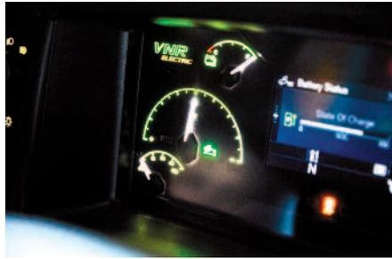
regenerativo puede aumentar el rango devolviendo energía hasta un 15% a la batería, dependiendo del ciclo de trabajo. La tecnología de monitoreo de batería transmite el estado de salud de la fuente de energía en tiempo real, agilizando las necesidades de servicio y
