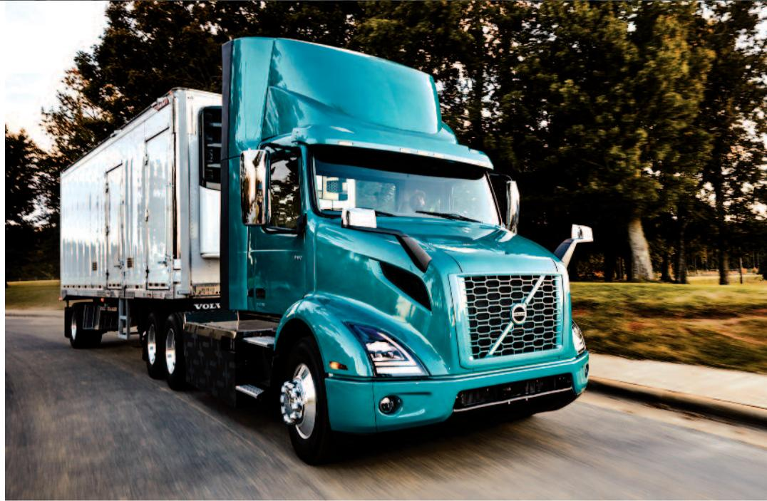
El VNR Electric está diseñado para aplicaciones de clientes y ciclos de conducción con rangos de distribución locales y regionales, que incluyen alimentos y bebidas y rutas de recogida y entrega. Las baterías de iones de litio de 264 kWh, que se cargan hasta un 80%
