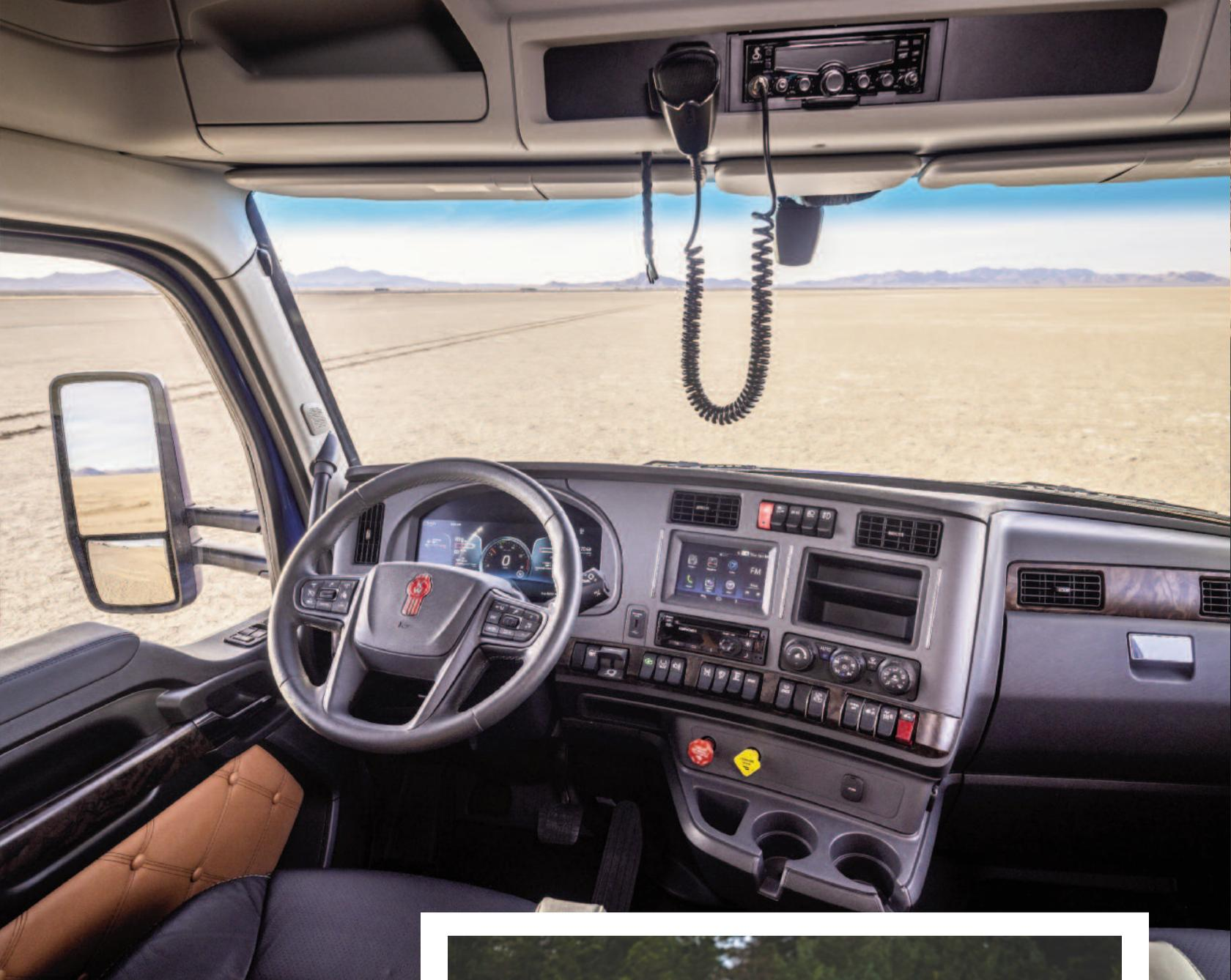
El mecanismo de dirección mecanizado también compensa algunas de las entradas manuales que los conductores necesitan realizar en la carretera. La cantidad de asistencia de torque se basa en la velocidad del vehículo. Las velocidades más altas obtienen menos asistencia y el resultado final es una sensación de dirección más ajustada y tradicional. Es más notable a bajas velocidades, donde la asistencia de torque hace que la dirección se sienta más ligera.
