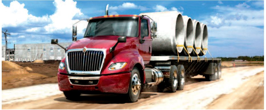
tres por ciento de esa eficiencia se debe a la aerodinámica gracias a elementos con menor resistencia al aire: cofre, defensa de tres piezas, apertura las ruedas, faldones y extensores laterales más largos que reducen el espa-
