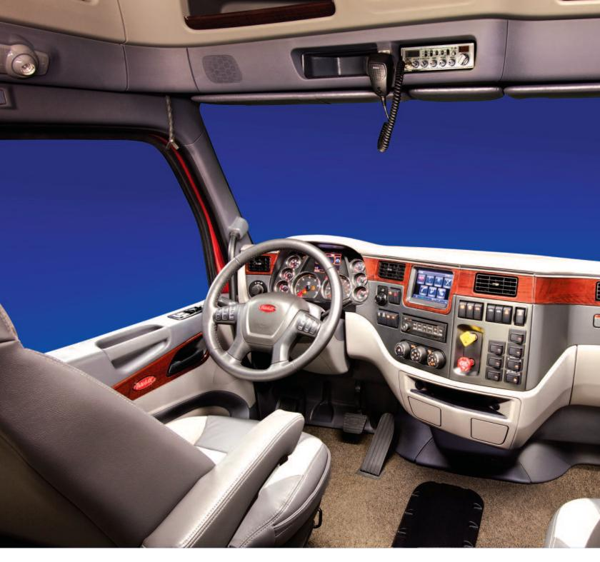
El parabrisas panorámico te da un dominio total del panorama e incluye localizadores integrados en la estructura de la cabina que permiten realizar reparaciones de buena calidad en poco tiempo. Por otro lado, como los postes A llevan soportes estratégicamente colocados para añadirles resistencia, estos pueden ser 13% más delgados que otros diseños, algo que repercute de manera positiva en la visibilidad.
