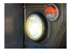
lente pueden admitir humedad, lo que puede causar corrosión en los terminales y el cable que conecta la lámpara al arnés. Si bien es posible que continúen funcionando, se deben marcar para su reemplazo la próxima vez que el vehículo esté en mantenimiento preventivo.
