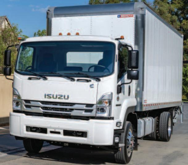
Los camiones Isuzu F-Series están motorizados por motores Cummins 6.7. Este motor con 6 cilindros en línea turbocargado de 6.7 litros con potencia de motor 260 caballos de fuerza y 660 lb-pie de torque
