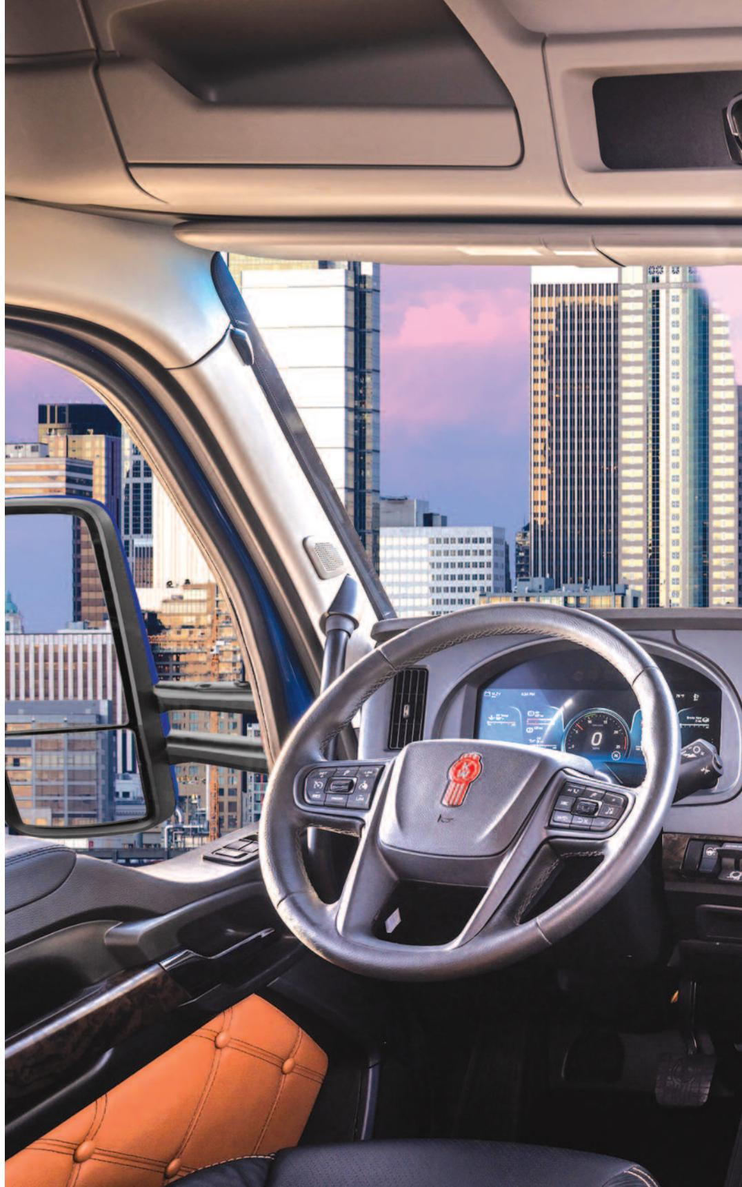
Los controles que incluyen la instrumentación, el control de crucero adaptativo y el teléfono y la radio se pueden controlar con solo presionar un botón en el volante (que Kenworth llama Next Gen SmartWheel). Con la incorpora-
