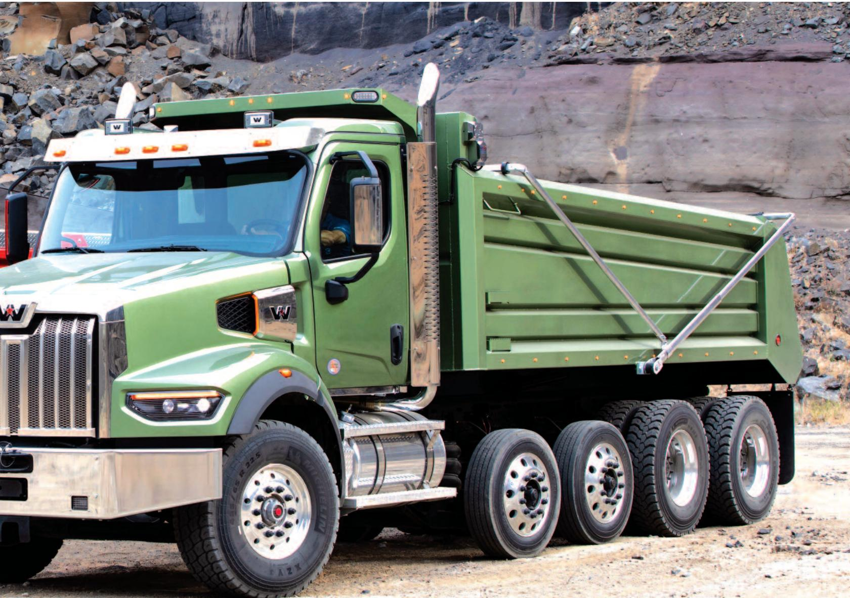
Un sistema de faros LED de dos etapas cuenta con una rejilla de calor impresa internamente y un sensor de temperatura del aire ambiente que puede derretir tres milímetros de hielo en menos de 10 minutos a -40 grados Fahrenheit o quemar a través de la condensación en ambientes cálidos y húmedos. Combinado con un patrón de luz de 45 grados, el sistema de faros proporciona una iluminación uniforme, larga y amplia.
