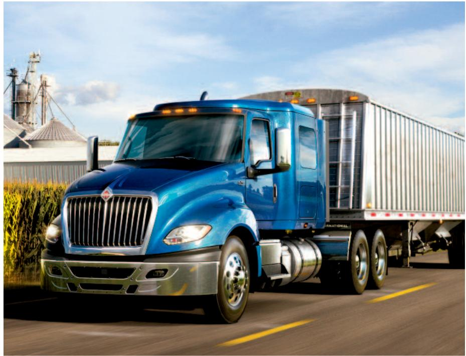
hace cuatro años era el más eficiente de la compañía, un ProStar 2017 con motor Cummins ISX15. El tres por ciento de esa eficiencia se debe a la aerodinámica gracias a elementos con menor resistencia al aire: cofre, defensa de tres piezas, apertu-
