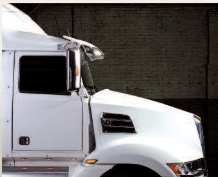
El camión tiene una apariencia más moderna sin perder la identidad y, evidentemente, con una buena aerodinámica. En esto jugaron un papel trascendental dos elementos: las orillas de la fascia, que envían el aire alrededor de las llantas y a la parte superior de la defensa, que por cierto es de cuatro piezas para reducir los costos de reparación.
