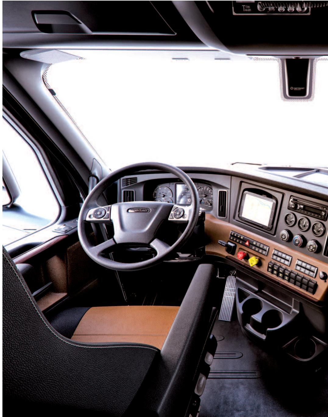
bajó de manera conjunta con Teague, los diseñadores de interiores de los aviones Boeing. Entre sus aportaciones hay manijas adicionales que facilitan el entrar y salir de la cabina y luces de LED en el techo que ofrecen una iluminación ambiente más difusa, la cual ayuda a reducir la fatiga visual. Además hay una nueva suspensión que hace más suave el trayecto pero que evita el bamboleo lateral.
