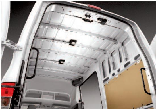
encontrarás 57 puntos de sujeción para que tu cargamento esté firmemente sujeto en todo momento. Los asientos están tapizados en tela de buena calidad, impermeable y con parches reforzados en los bordes para soportar los rigores del trabajo. Además, son bastante cómodos y ajustables en diferentes posiciones, lo cual te facilitará encontrar la postura de manejo más confortable, especialmente si tomamos en cuenta que el volante multifunción es ajustable en altura y profundidad. >>
