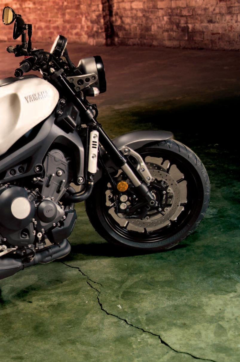
cuatro pistones y un disco de 245mm atrás, ambos ejes equipados con el muy útil sistema ABS. Con una altura de 32.7 pulgadas y una distancia libre al piso de 5.3", esta moto tiene las medidas clásicas de las naked streetfighter, diseñadas para las calles -pavimentadas- de una ciudad, no para terrenos accidentados. Los rines son de 17 pulgadas y 10 rayos.
