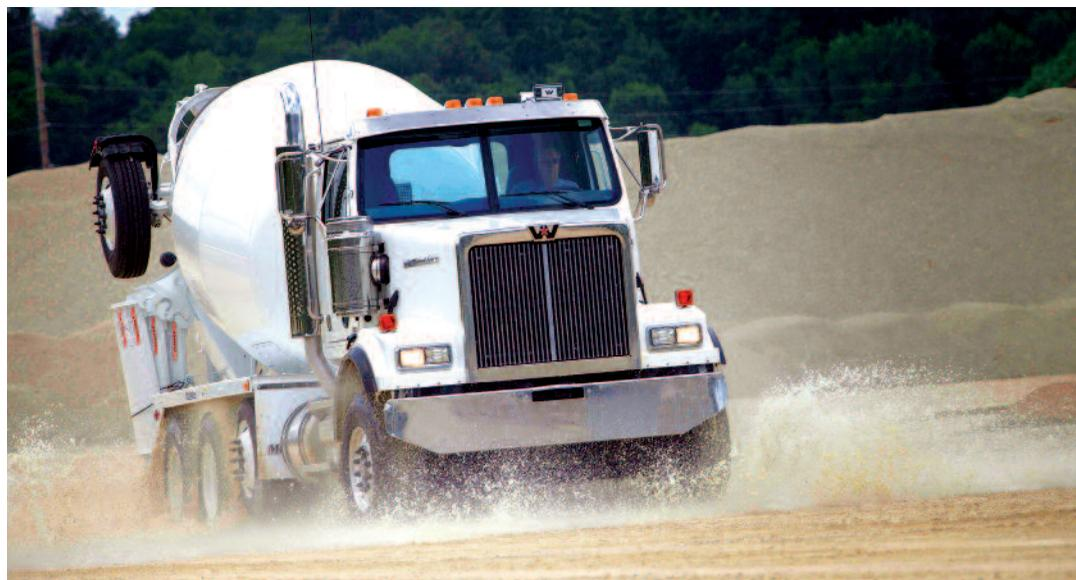
emisiones contaminantes. Gracias a una curva de potencia bastante amplia y plana, el motor logra que el conductor pueda mantener el pie izquierdo lejos del clutch y las manos en el volante, lo que hace menos cansado el viaje al tener que hacer menos cambios de velocidad.
