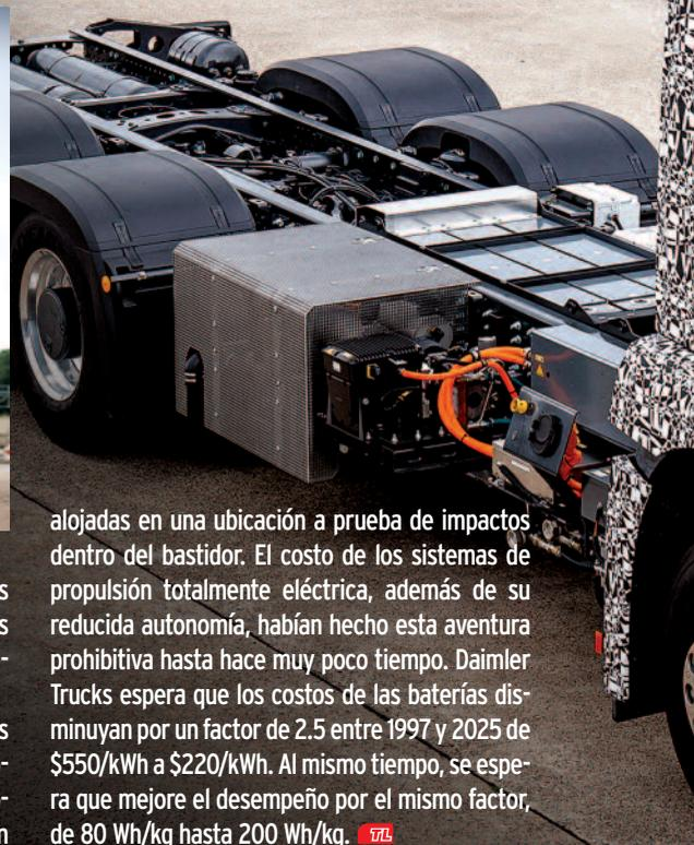
alojadas en una ubicación a prueba de impactos dentro del bastidor. El costo de los sistemas de propulsión totalmente eléctrica, además de su reducida autonomía, habían hecho esta aventura prohibitiva hasta hace muy poco tiempo. Daimler Trucks espera que los costos de las baterías disminuyan por un factor de 2.5 entre 1997 y 2025 de \$550/kWh a \$220/kWh. Al mismo tiempo, se espera que mejore el desempeño por el mismo factor, de 80 Wh/kg hasta 200 Wh/kg. **TTL**
