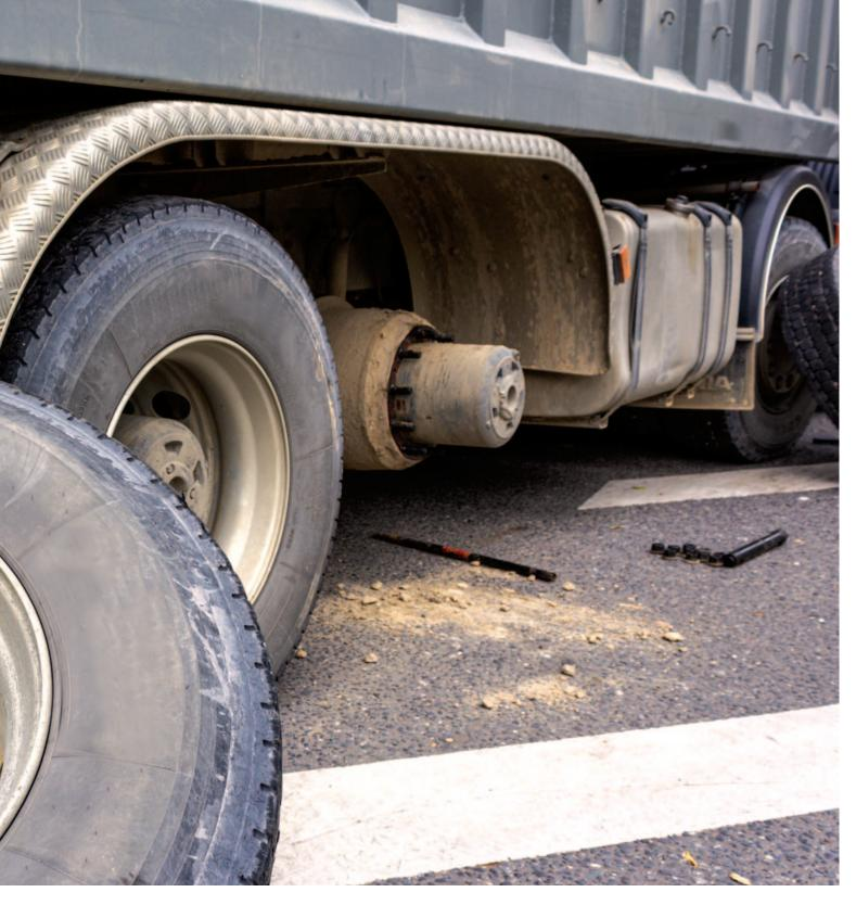
para obtener la fuerza de sujeción adecuada en la rueda. "El torque es crítico porque el perno se estira como un resorte; si no se aplica el par correcto, no se obtendrá la carga de sujeción correcta", explica David Walters, gerente de garantía y servicio de campo de Arconic, que fabrica llantas Alcoa. "Por lo tanto, se podría aplicar un torque insuficiente para tener ruedas sueltas o un torque excesivo y ceder [estirar] el perno. El exceso de torsión es el más común en la industria".
