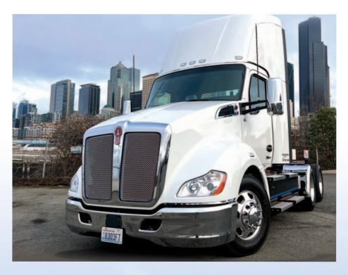
MX-13 de 12,9 litros ofrece hasta 510 caballos. El T680 con motor diésel alcanza hasta 1,850 Ib-pie. torque en las ruedas, mientras que la versión totalmente eléctrica alcanza un máximo de 1,632 lb-pie. Pero el T680E tiene un acceso más rápido a ese torque que su contraparte diésel, que tiene que acelerar y pasar por varias marchas: 18 en el caso de las nuevas transmisiones manuales automatizadas TX-18 y TX-18 Pro de Paccar. No es así con
