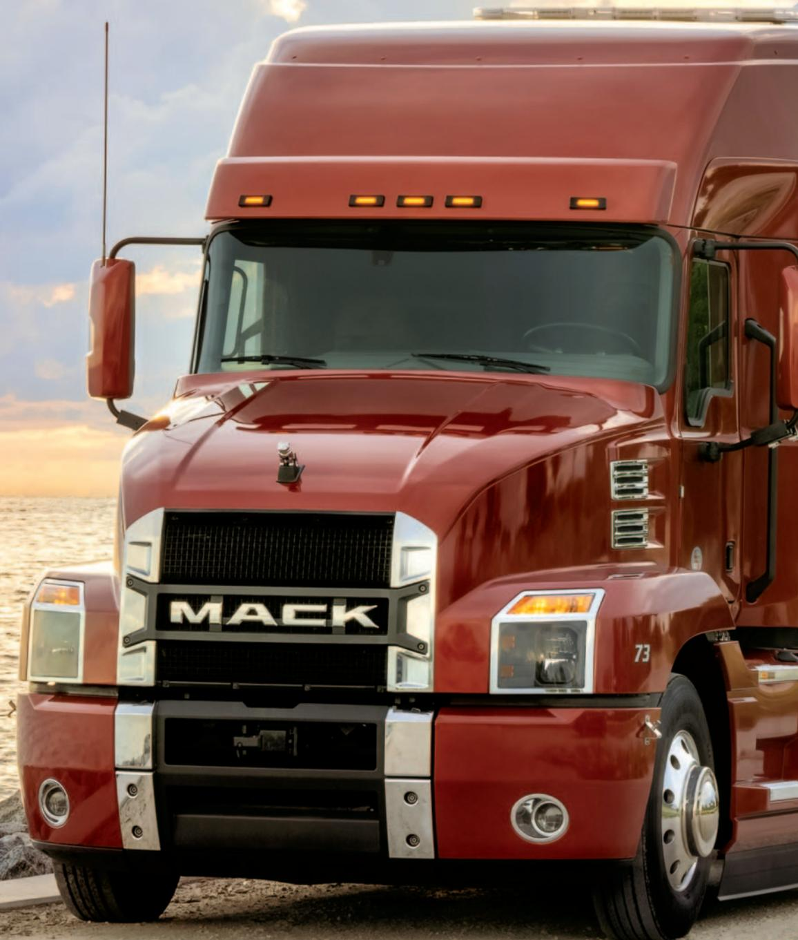
robusta, grande y estructurada parrilla recuerda al SuperLiner, mientras que las salpicaderas planas y de marcadas líneas son un guiño al RD Model. Los diseñadores e ingenieros de Mack utilizaron modelación avanzada por computadora y realizaron pruebas en el Centro Espacial Kennedy para crear unas líneas que redujeron la carga aerodinámica un seis por ciento y ayudaron a incrementar la eficiencia de combustible hasta un tres por ciento comparado con un Pinnacle con equipamiento similar.
